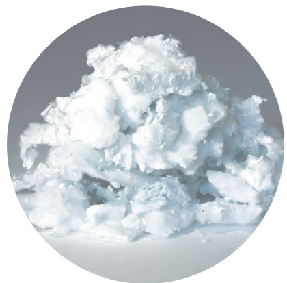
窒化アルミニウム単結晶の「サーマルナイト」はファイバー状。見た目は綿のようだが
